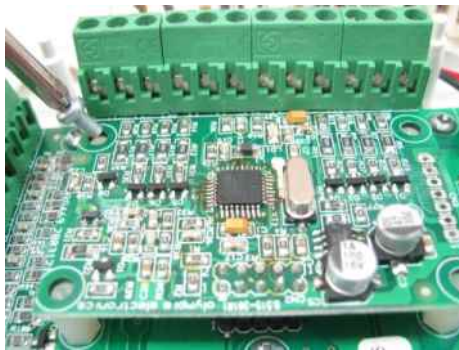
Σχήμα 5 : Βίδωμα της πλακέτας BS-469.
