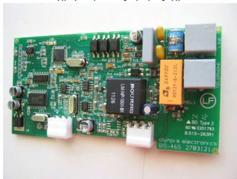
Σχήμα 1 : Κάτοψη πλακέτας BS-465 .
