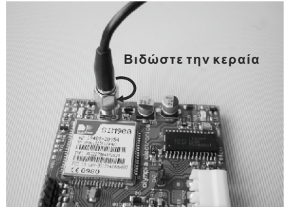
Σχήμα 4 : Τοποθέτηση κεραίας στην πλακέτα BS-464.
